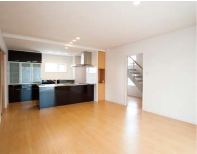
軽量鉄骨の家のもう一つのメリットが、空間設計の自由度である。広い床面積を壁面だけで支えることができるため、余分な柱や壁などが必要ない（E邸）
