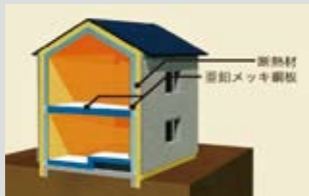
亜鉛メッキ鋼板の外側をぐるりと断熱材で囲んだBPS工法の外断熱
